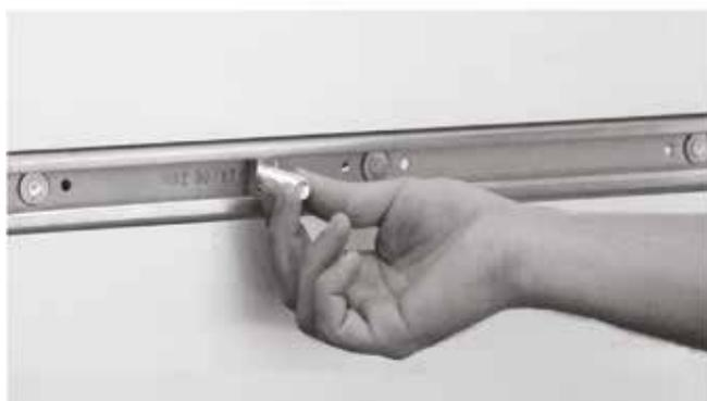
Die Verbindung von Bauteilen mit den Schienen erfolgt durch Hammer-/Hakenkopfschrauben und Gewindeplatten. Die Schrauben werden horizontal in die Schiene eingeführt und um 90° nach rechts gedreht – das verriegelt sie in der Schiene.
