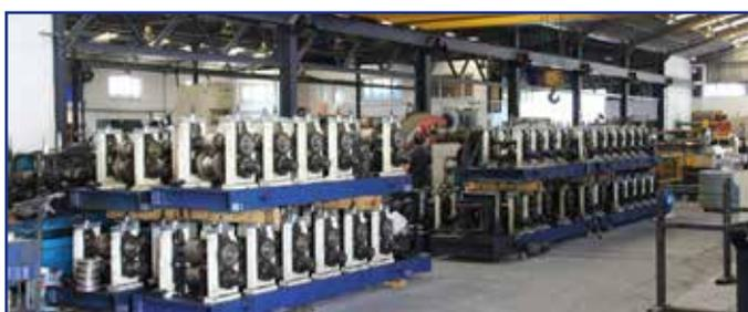
*Profiliermaschinen zur Herstellung von Ankerschienen*
