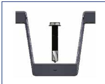
Die Befestigung erfolgt ohne das Vorbohren von Löchern mit selbstschneidenden Schrauben und Schlagschrauber (mit 1500 U/min).
