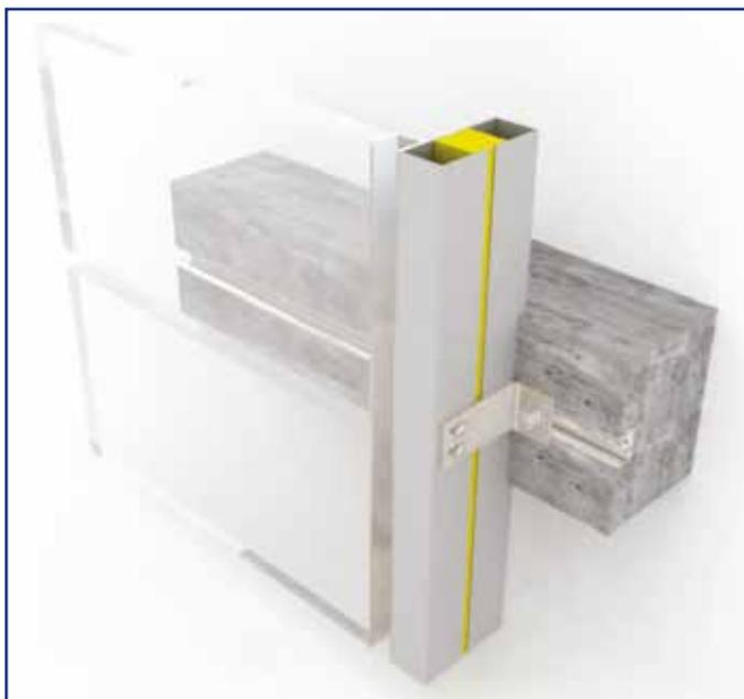
Ankerschienen sind für die Montage von Vorhangfassaden prädestiniert. Dabei werden modularisierte Platten aus Materialien wie Glas oder Naturstein an den Vorhangfassadenplatten montiert. Diese Elemente werden dann zur Gebäudefassade aufgebaut. Sie können mit Hammerkopfschrauben und speziellen Halterungen schnell, einfach, wirtschaftlich und sicher an den Ankerschienen befestigt werden.
