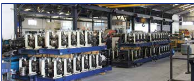
Profiliermaschinen zur Herstellung von Ankerschienen
