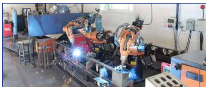
Schweißroboter im Einsatz
