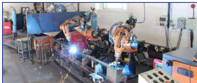
Schweißroboter im Einsatz
